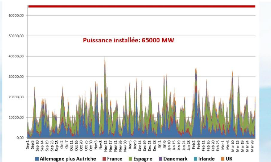
**Puissance injectée sur le réseau par le parc éolien européen, de septembre 2011 à mars 2012 (pas de temps horaire). Source Sauvons le Climat, novembre 2011, sur données exploitants de réseaux**
